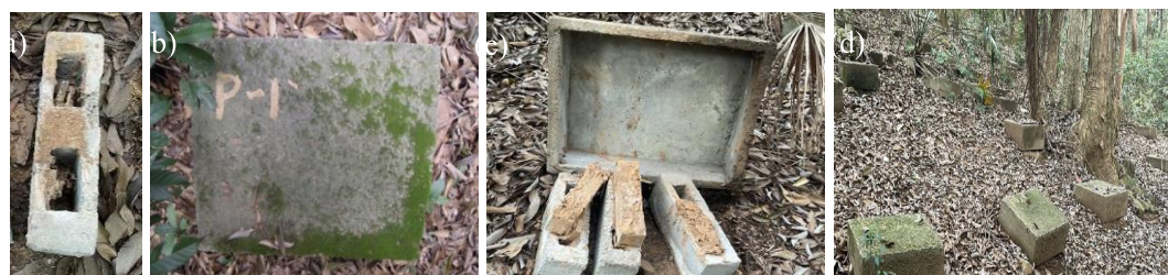
（a）空心混凝土块 （b）混凝土箱顶视图 （c）混凝土箱内的样品 （d）户外试验场地视图
