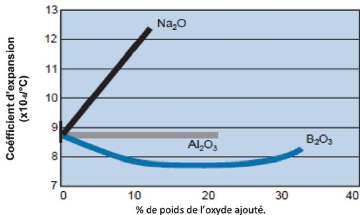
Réduction du coefficient de dilatation linéaire du verre lorsque la silice est remplacée proportionnellement par de l'acide borique. Cela facilite « l'ajustement thermique » dans les émaux céramiques et la résistance à la chaleur dans le verre borosilicaté.
